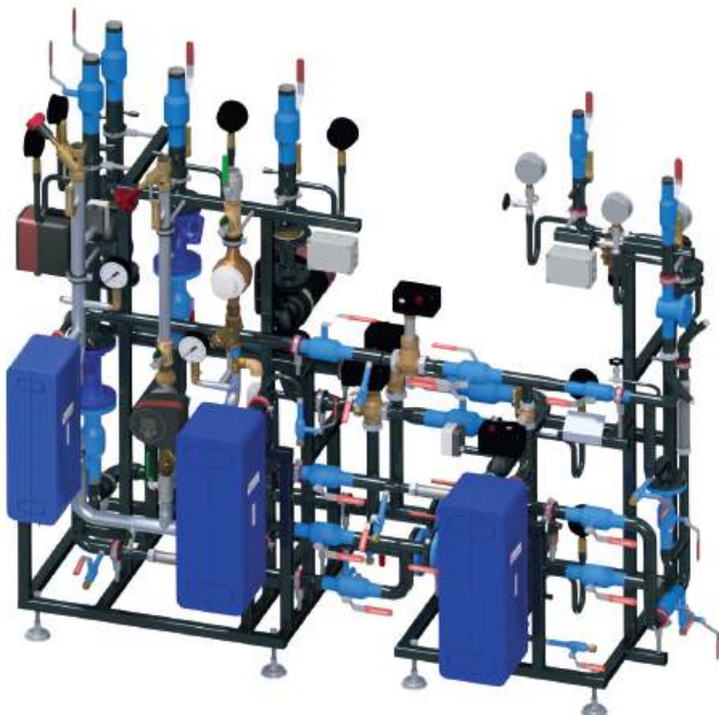
306 kW aqoFrame mit Trinkwasser Vor- und Nachwärmer zur Absenkung der Rücklauftemperatur und zwei gemischten Heizkreisen
