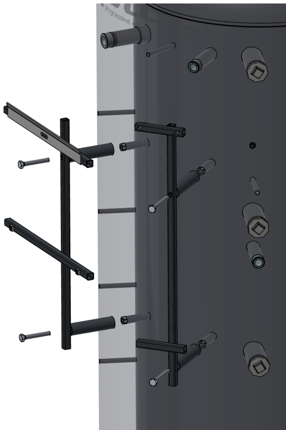
Abbildung 7 Montage der Befestigungskonsolen
