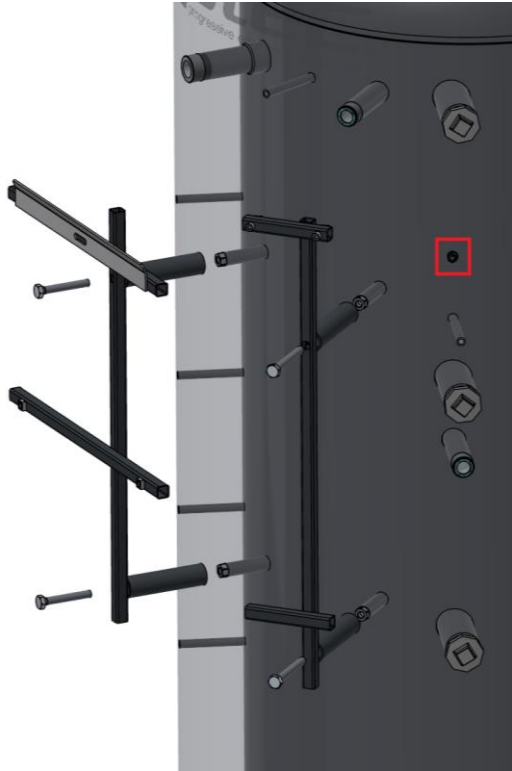
Abbildung 14 M8-Gewindebolzen am aqoNPS D Pufferspeicher
